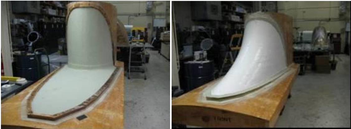
Figure 2-10. Cusp inner skin and Syntactic Foam pour (Juska et al, 2012)
